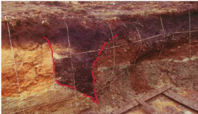
Excavación paleosísmica Morro de los Hoyos, con evidencia de grieta abierta rellena por materiales turbosos, que evidencia uno de los sismos ocurridos sobre la traza norte de la falla de Boconó en la cuenca en tracción de Apartaderos, estado Mérida. Fuente: Franck A. Audemard (1997).
