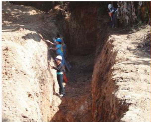
Excavación paleosísmica Santa Rosa, en la traza de la falla El Ávila. Fuente: Luz M. Rodríguez (2008).
