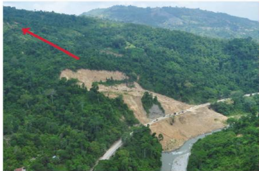
Deslizamiento de tipo trasnacional sobre la troncal 007 en la vialidad que conecta los poblados del Vigía y Mérida. La Flecha indica el progreso que puede tener del deslizamiento hacia la cima de la montaña. Fuente: Vuelo en helicóptero CIGIR-INPRADEM (2013).
